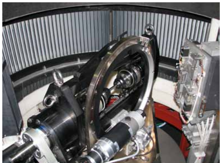
Fig 4: Rotatable tensile rig at diffractometer SPODI.
