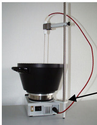
Estructura con baño de 4 litros, montante para baño de 4 litros y sensor térmico
