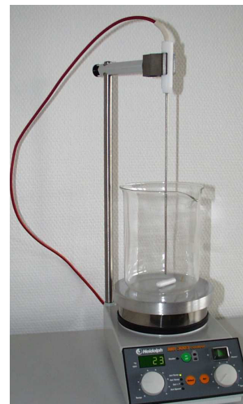
Estructura con montante y soporte para el sensor térmico
